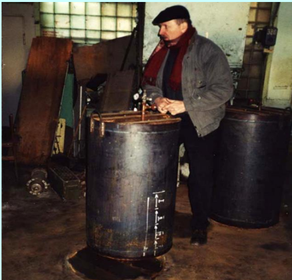
Фильтр с загрузкой из нескольких видов сорбентов – гидрофобизированных перлита и керамзита, 0,23 куб.м
