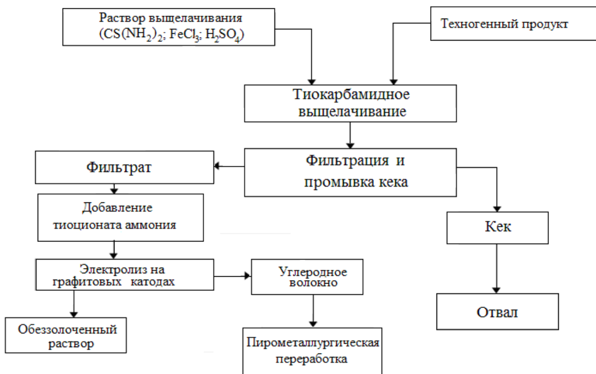
Рисунок 9 - Схема извлечения золота из техногенных отходов на основе тиокарбамидного выщелачивания (пирометаллургическая)
