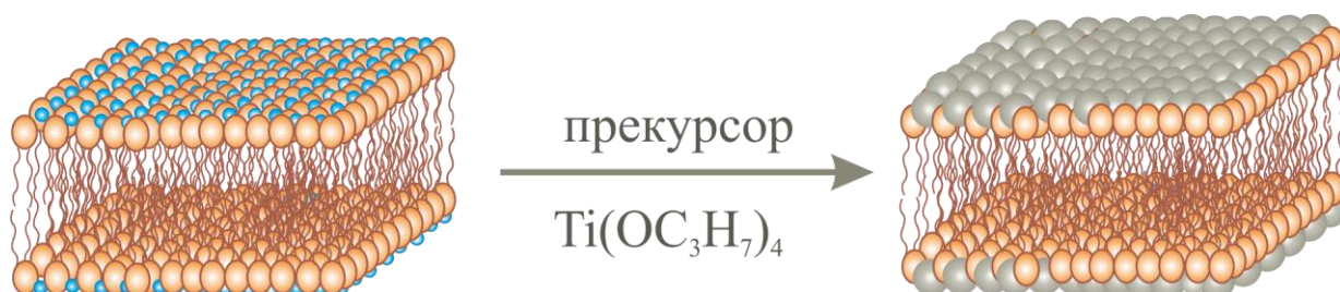
Рис. 12. Схематическое изображение формирования \text{TiO}_2 на бимолекулярном слое L_\alpha -мезофазы. Вода показана голубым цветом
