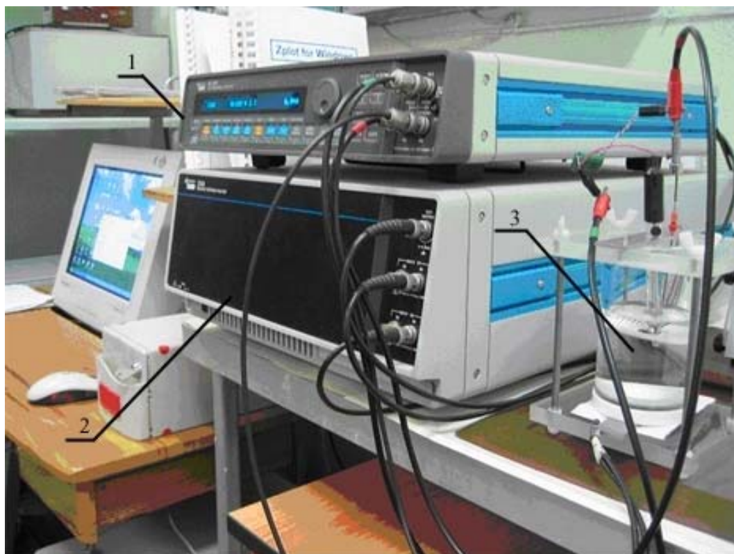
Рисунок 2.3 – Внешний вид экспериментальной установки, представляющей собой электрохимическую систему 12558WB: 1 – электрохимический интерфейс SI 1287, 2 – анализатор частотного отклика FRA 1255B, 3 – электрохимическая ячейка K0306 Flat Cell
