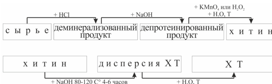
Рисунок 1.3 – Схема получения хитина и ХТ. Рисунок построен по данным работы [10]. Детали обсуждаются в тексте.
