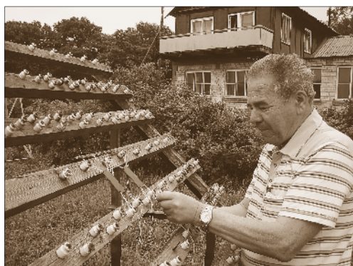
Ю.М. Каплин проводит атмосферные коррозионные испытания металлов с защитным красочным покрытием. 2011 г.
