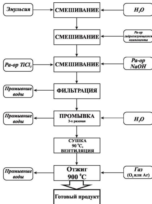
Рисунок 1. Общая и принципиальная схемы синтеза пористых оксидных материалов на основе вольфрама и молибдена.
